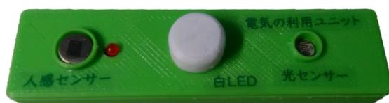
光センサー・LED・人感センサーの3種が内蔵された製品（ユーレカ工房）
