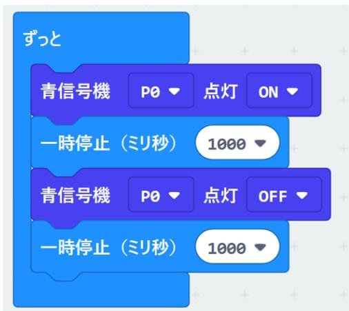
4. 点滅させるプログラムを作るには、ON/OFF 以外に、時間の制御が必要なることを確認する。
