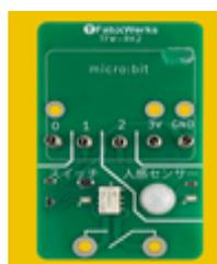
人感センサーとリレーが組み合わさった製品（Tfab Works）
